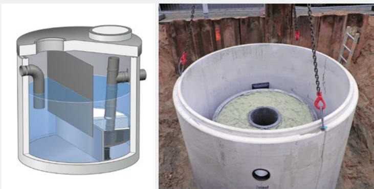
Fig. 6 Substratfilter aus Betonfertigteilen mit Funktionselementen, die das zu reinigende Wasser horizontal durchfließt. Das ermöglicht Sedimentation, Filtration und Adsorption. Die anschliessbare Verkehrsfläche hängt von der Modellgrösse des Filters ab. (© Mall)
