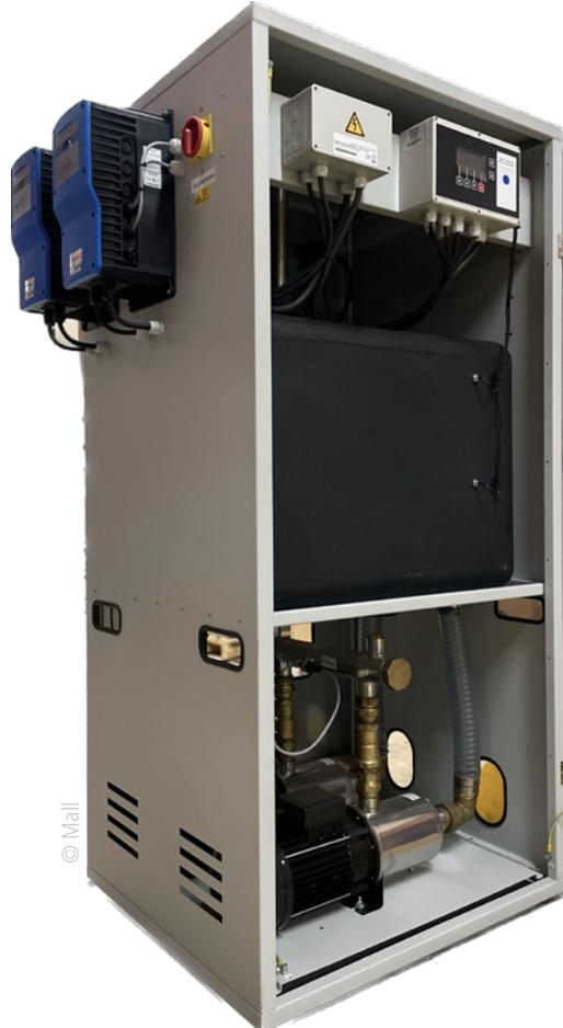
Abb. 4: Regenwassercenter Tano XL für die Regenwassernutzung in Gewerbe und Industrie. Es enthält zwei Pumpen zur Druckerhöhung, einen Frequenzumrichter, ein System zur Trinkwassernachspeisung mit Zwischenbehälter, eine LCD-Anzeige und weitere vormontierte Einzelteile.
