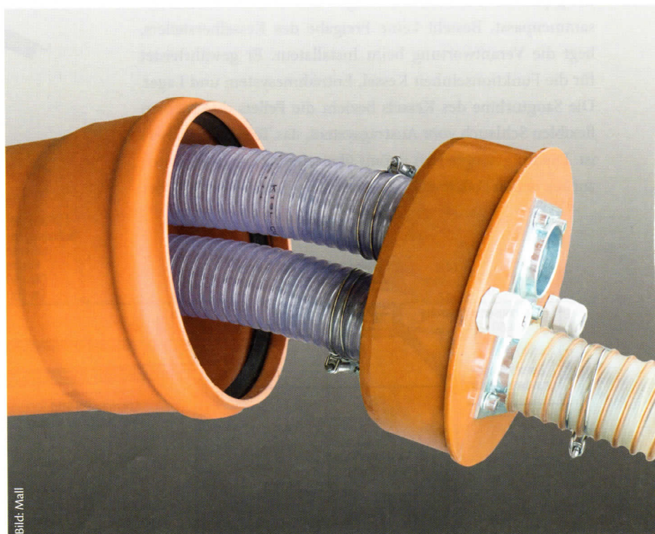
Adapterplatte im unterirdischen Pelletspeicher ThermoPel. Verbindungsleitungen zwischen pneumatischem Entnahmesystem Maulwurf 3000-E3 und dem Heizkessel verlaufen in einem Leerrohr zwischen Speicher und Gebäude
