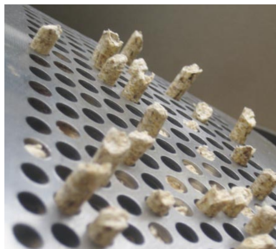
Das Rohmaterial, Späne und Hackschnitzel aus dem Sägewerk, wird in Pressen unter hohem Druck durch eine Stahlmatrize gedrückt. Der Druck erzeugt Wärme, die das im Holz enthaltene Lignin verflüssigt, wodurch es als natürliches Bindemittel fungiert.
