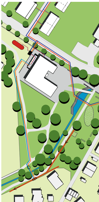
Bild 1: Heizzentrale im neuen Rathaus, Armaturenschacht (schwarz) und Pufferspeicher (rot). Primärkreislauf vom Abwasserkanal (braun) zu den Wärmetauschern, Sekundärkreislauf des Kalten Nahwärmenetzes zu den Hausanschlüssen. © Energiedienst
